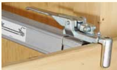
Einfache Sicherung an Bordwänden
